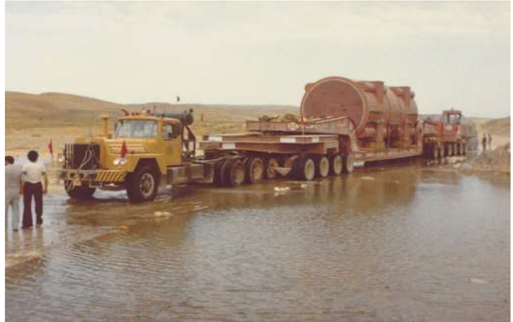
イランタブリツ発電所納め ステータの輸送作業
