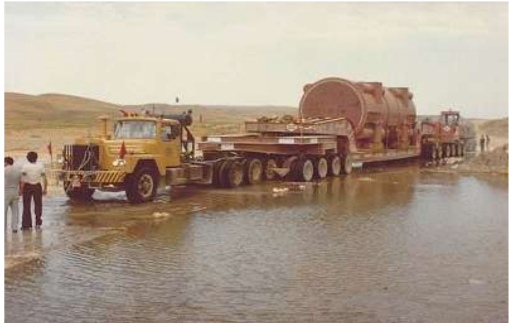
イランタブリッツ発電所納め ステータの輸送作業
