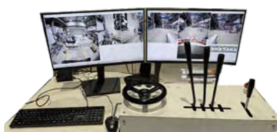
広視野カメラ映像とAR補助線により、走行・荷役を直感的に操作できる遠隔フォークリフト専用インタフェース
