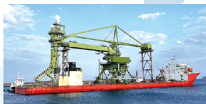
国内港湾向け荷役設備の自航式バージによる輸送
